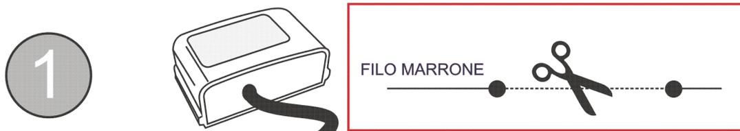
Per remotizzare l'informazione di allarme scattato, sarà necessario interrompere il filo MARRONE del modulo Gateway WI2.0, isolare il capo proveniente dal connettore bianco a 6 pin.
